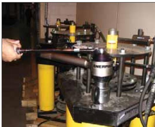
◀ Ручной мультипликатор с упорной перекладной модели E393 от Enerpac используется для затяжки болтов вручную с усилием до 4300 Нм.
